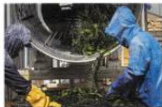
収穫したわかめを凍結した工場に運び入れ、すぐに塩もみ。90℃前後に加熱された湯水で煮る。すぐに湯水で冷やす。
